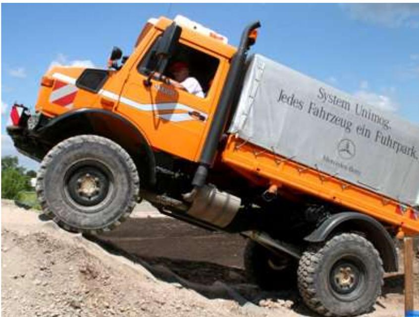
**Abb. 2.1-29:** Mercedes Unimog im Geländeeinsatz, max. Steigung ca. 100%.
