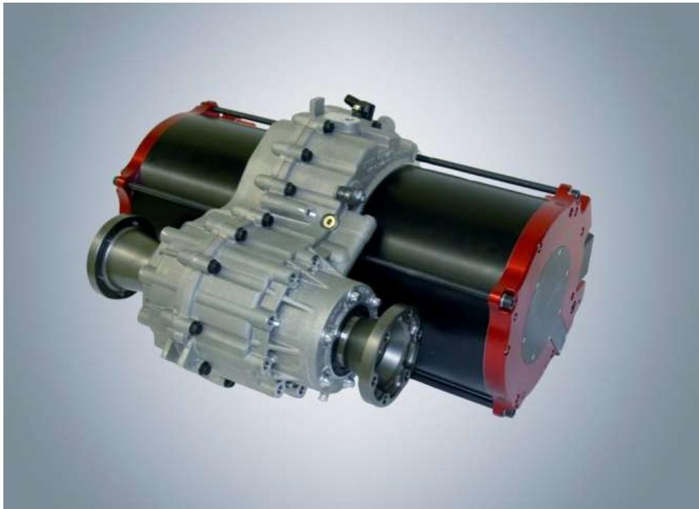
Gewicht: 150 kg (trocken), Max. Motormoment:  $2 \cdot 300 \text{ Nm}$ , Max. Antriebsmoment:  $2 \cdot 1650 \text{ Nm}$ , 2 Getriebestufen, Gesamtübersetzung: 5,5, Max. Antriebsdrehzahl  $12.000 \text{ 1/min}$ .
