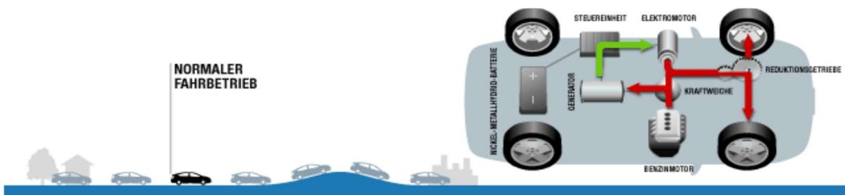
**Abb. 3.2-67:** Toyota Prius, HYBRID SYNERGY DRIVE, normaler Fahrbetrieb.
