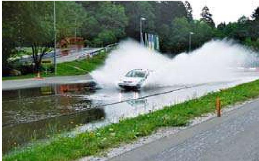
**Abb. 2.1-11:** Wasserverdrängung bei geschlossenem Wasserfilm.
