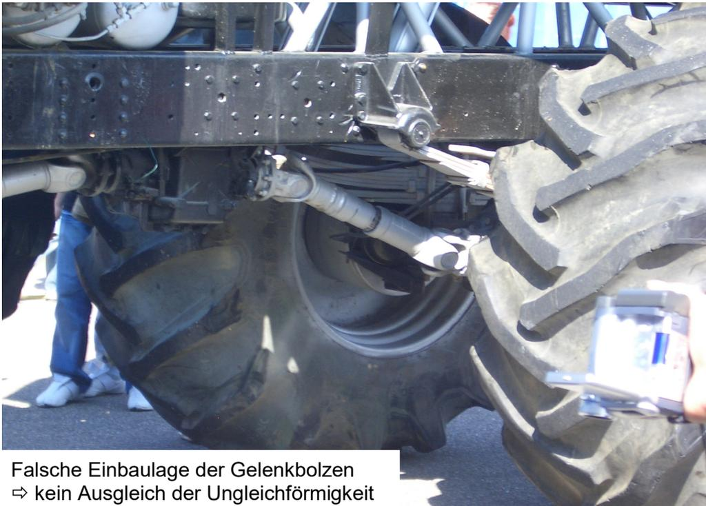
**Abb. 5.2-6:** Kardangeln in Antriebswelle eines Allradfahrzeugs, Beispiel für falschen Einbau.
