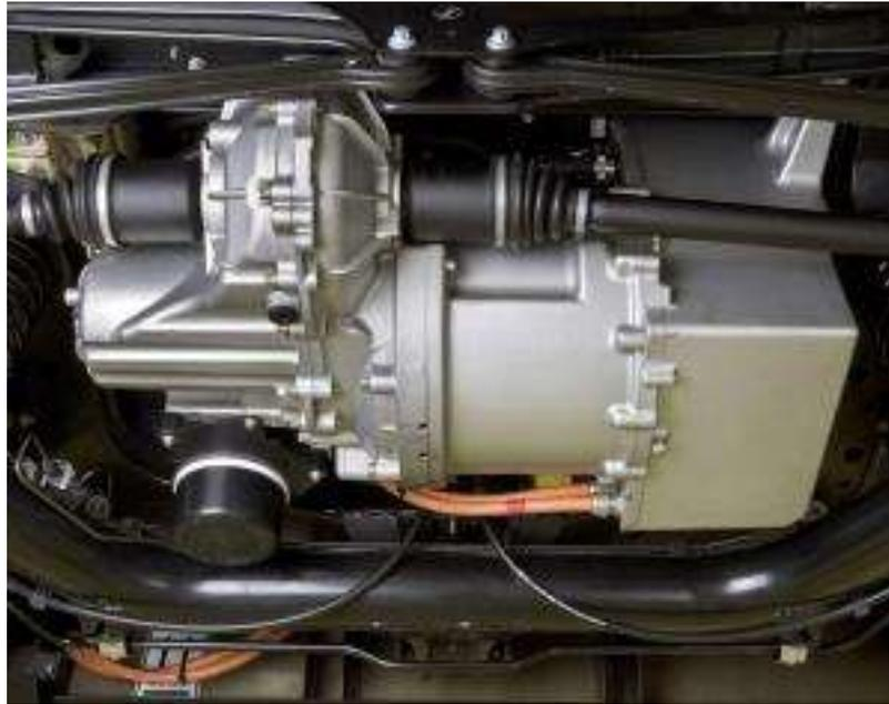
**Abb. 3.2-46:** Zentralmotor in einem elektrisch angetriebenen Smart fortwo (Modelljahr 2012)
