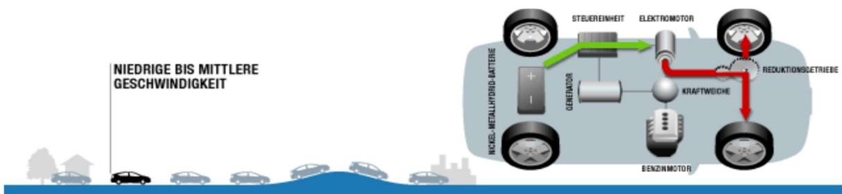
**Abb. 3.2-66:** Toyota Prius, HYBRID SYNERGY DRIVE, niedrige bis mittlere Geschwindigkeit.
