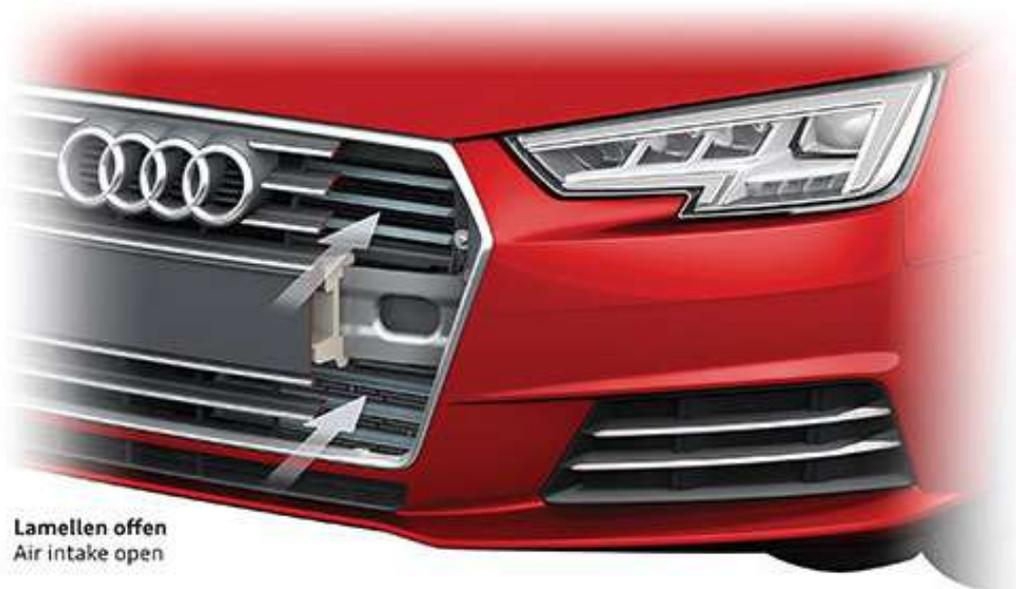
**Abb. 2.1-24:** Elektronisch geregelte Lamellen zur Steuerung des Luftstroms über das Fahrzeug (niedriger Luftwiderstand) oder durch den Kühler (bessere Kühlleistung)
