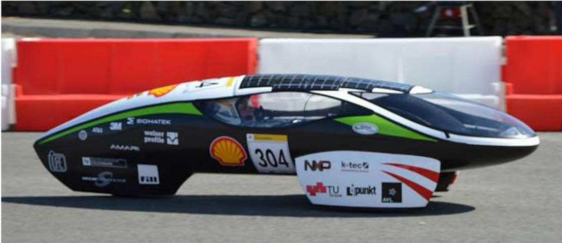
**Abb. 2.1-25:** Fenek 2014 (TU Graz, Österreich):  $c_d = 0,07$ . Gewinner Shell Eco Marathon 2014 in der Kategorie Prototyp Battery Electric mit 1091,6 km/kWh, entspricht etwa 10433 km/l Superbenzin.
