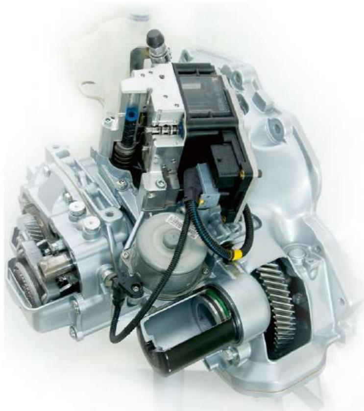
**Abb. 4.2-34:** Schnittmodell eines automatisierten Fünfgang-Schaltgetriebes von Opel
